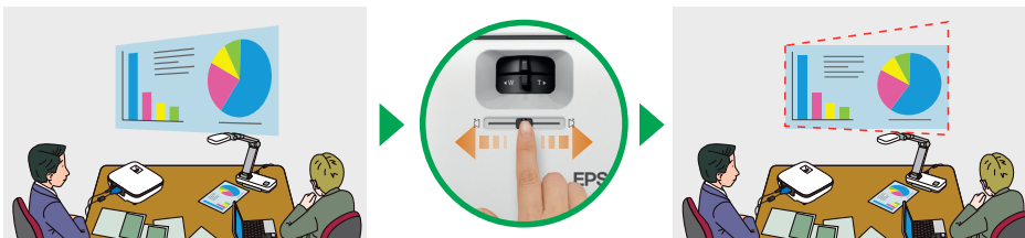
Dispositivo de ajuste de corrección Keystone horizontal: este nuevo e intuitivo control de deslizamiento te permite ajustar las imágenes a la forma correcta cuando el proyector se encuentre en ángulo con respecto a la pantalla.
