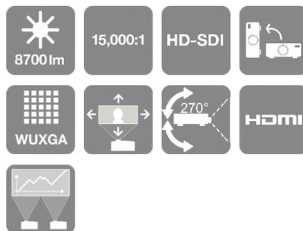
El EB-Z9870U blanco es un impresionante y versátil proyector de instalación que cuenta con una luminosidad de 8.700 lúmenes y resolución WUXGA. El EB-Z9870U, que puede proyectar en posición vertical para cartelería digital, cuenta con un ángulo de instalación flexible, desplazamiento de la lente para posicionamiento descentrado y gran cantidad de opciones de calibración, con conectividad Wi-Fi opcional y HDBaseT.
