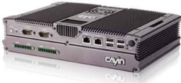
Compacto y robusto servidor de señalización digital exclusivo que permite una eficaz administración del equipo multimedia, actualización de contenidos, programación centralizada y transmisión de vídeo por streaming.
